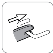
ISOFIX-Verankerung zur Befestigung
